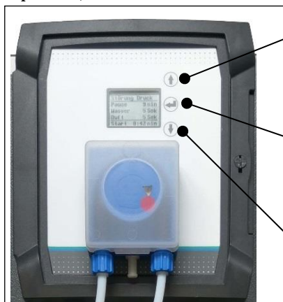
Рис. 12, Элементы управления на дисплее
