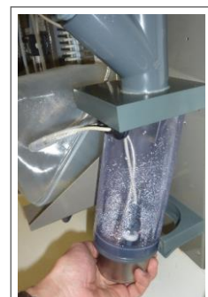
Рис. 16, Снятие бака распылителя
