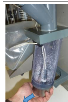
Рис. 13, Снятие бака распылителя
